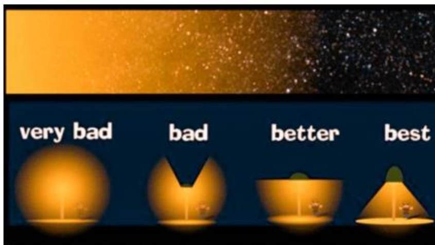
Figura nr. 5-4 Exemplu al unui sistem de iluminare adecvat pentru concentrarea dispersiei exclusiv asupra carosabilului
