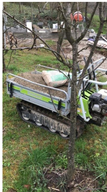
Figura 4. Minidumper pe șenile din cauciuc a cărui utilizare pe terenuri fragile asigură o protecție a solului și a covorului de vegetație
