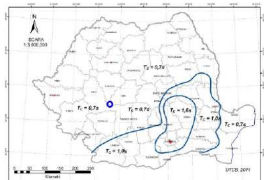
Figura 3.2 Zona de teritoriu România în termeni de perioadă de control ( T_c ) a spectrului de răspuns
