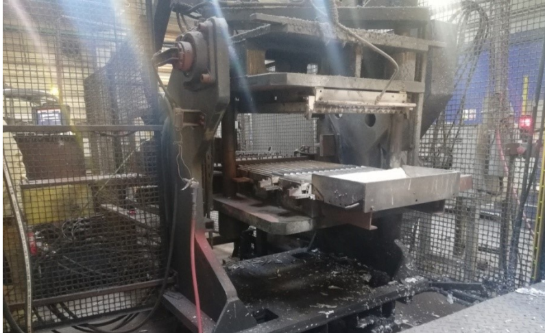
Fig. 13 Mașina de turnare (automată IPAD)
