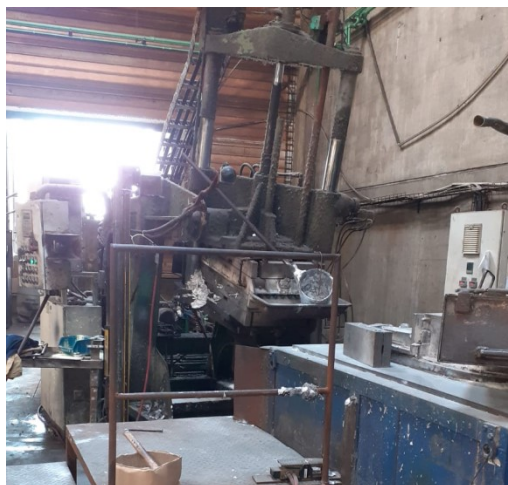
Fig. 14 Mașina de turnare (automată)
