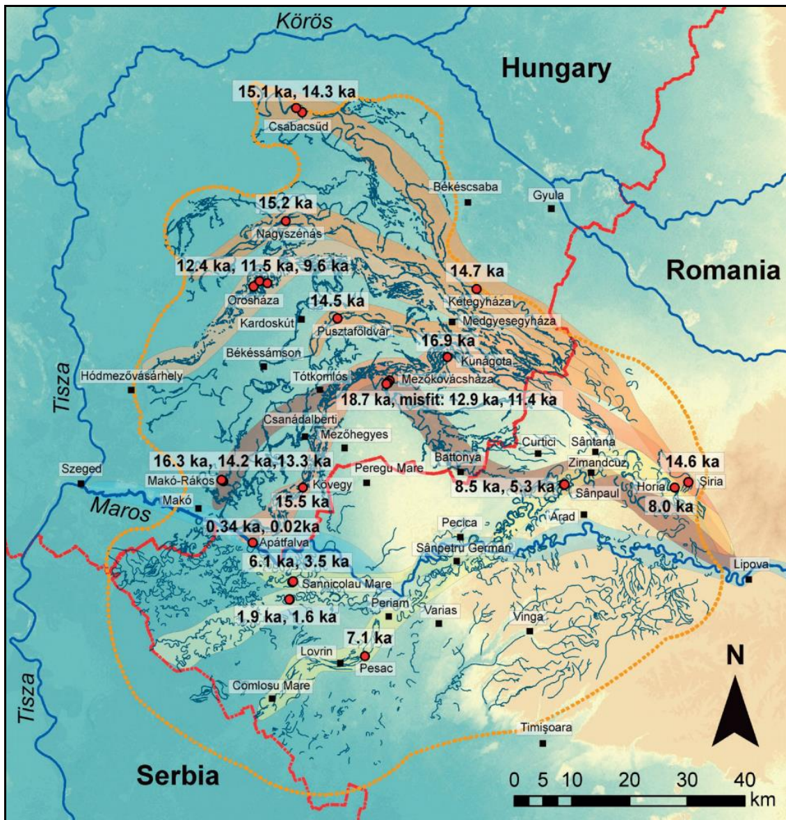
Fig. 2.1.2.4. Principalele generații de albies ale râului Mureș și vârsta acestora în cadrul conului său aluvionar (după Sipos et al. , 2012).
