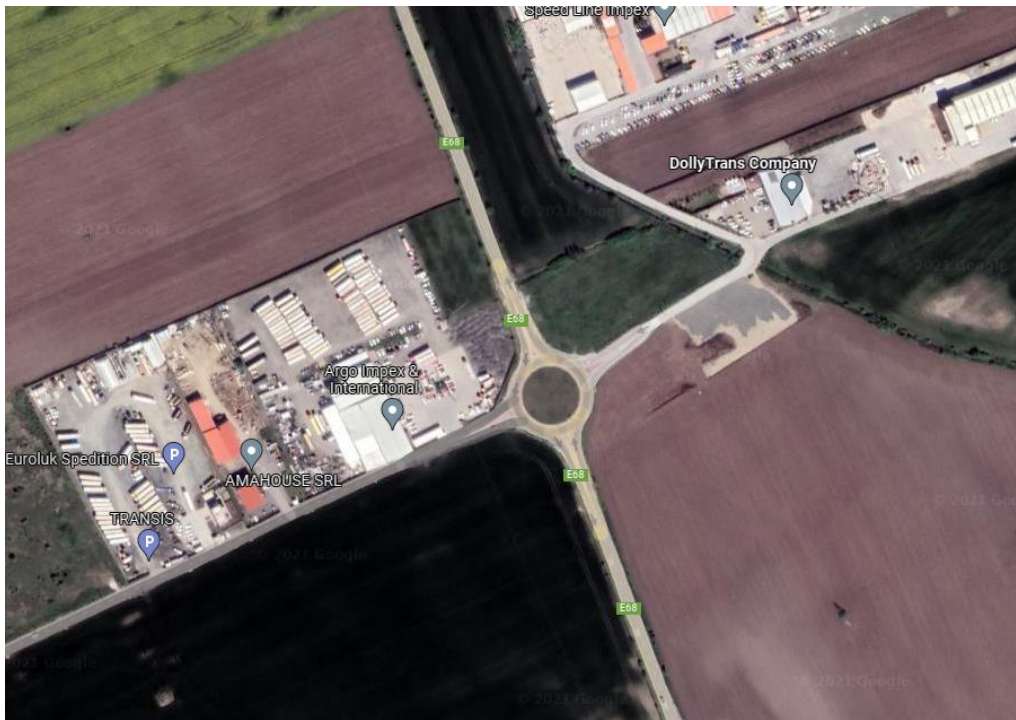
Figura 2.3.9.1.5. Accese laterale din centură prin amenajare intersecție giratorie cu restricție de viteză locală la 30 km/h. Sursa: Google Maps.
