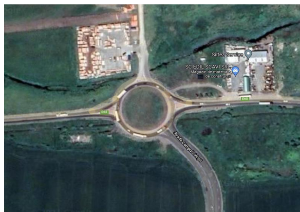
Figura 2.3.9.1.10. Intersecție giratorie Centura Nord cu Str. Câmpul Liniștii, cu accese în vecinătate necontrolate. Sursa: Google Maps.
