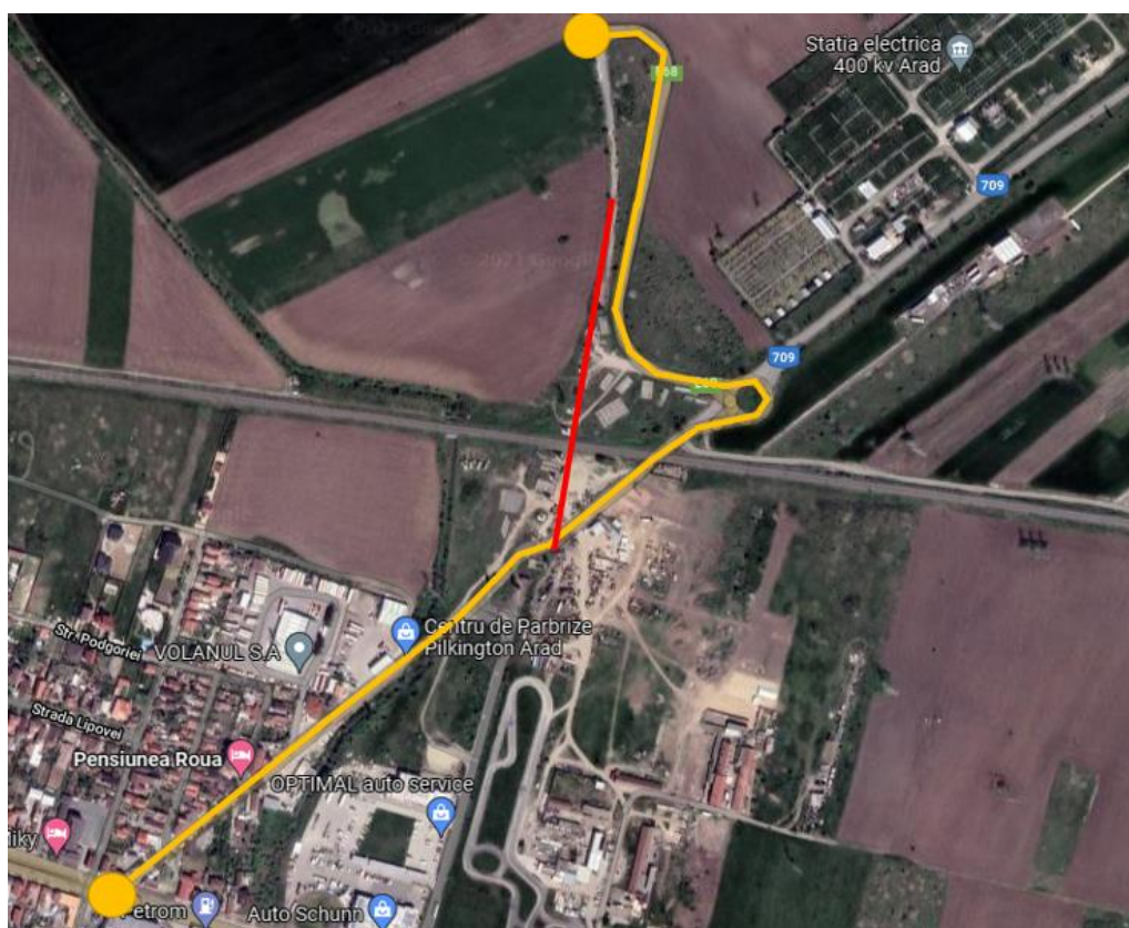
Figura 2.3.9.1.4. Pasaj (—) în execuție peste CF Arad - Deva și traseu provizoriu (—) pe DJ 709 cu trecere la nivel. Sursa: Google Maps.
