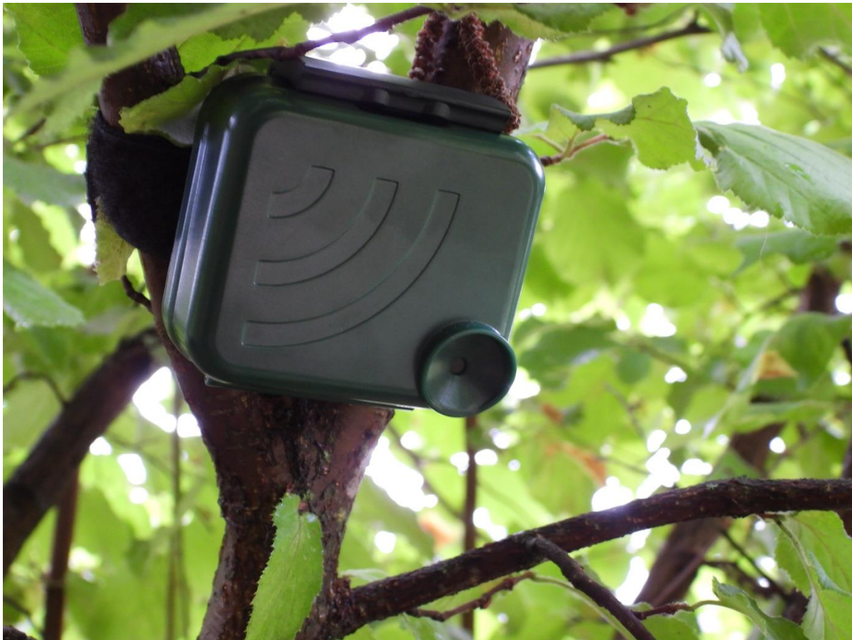
Figura XIII.C.2. AudioMoth instalat pentru înregistrarea păsărilor pe amplasamentul proiectului
