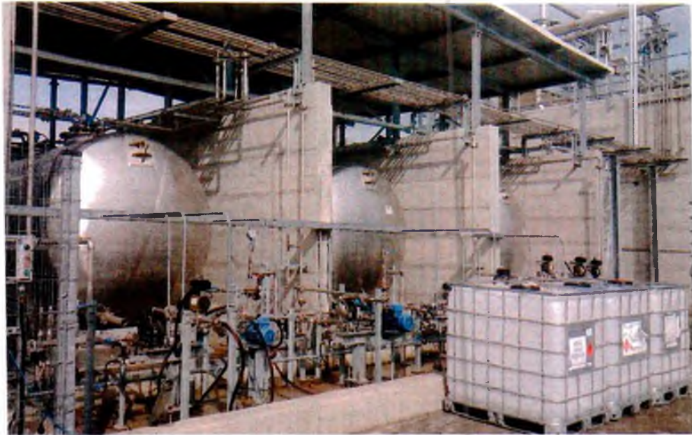
Foto 5 – Colectare pe fractii a produsilor de distilare
