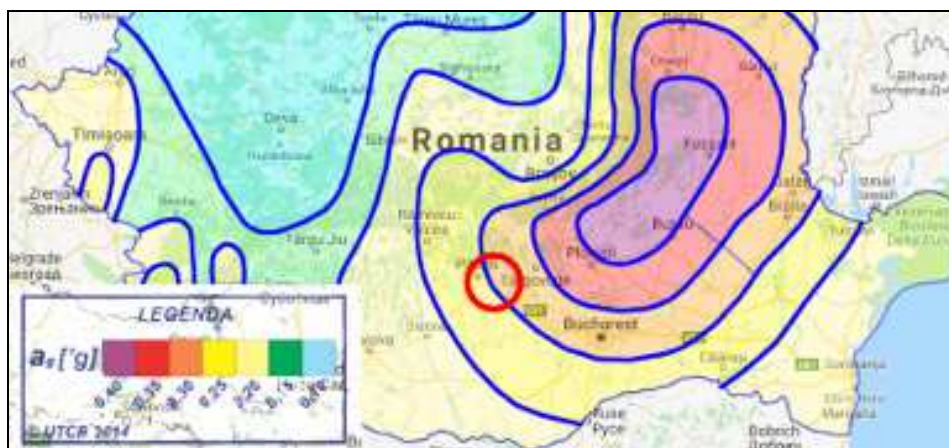
Fig. 29. Zonarea valorilor de vârf ale acceleratiei terenului pentru proiectare a_g = 0.25 g cu IMR=225 ani si 20% probabilitate de depasire in 50 ani
