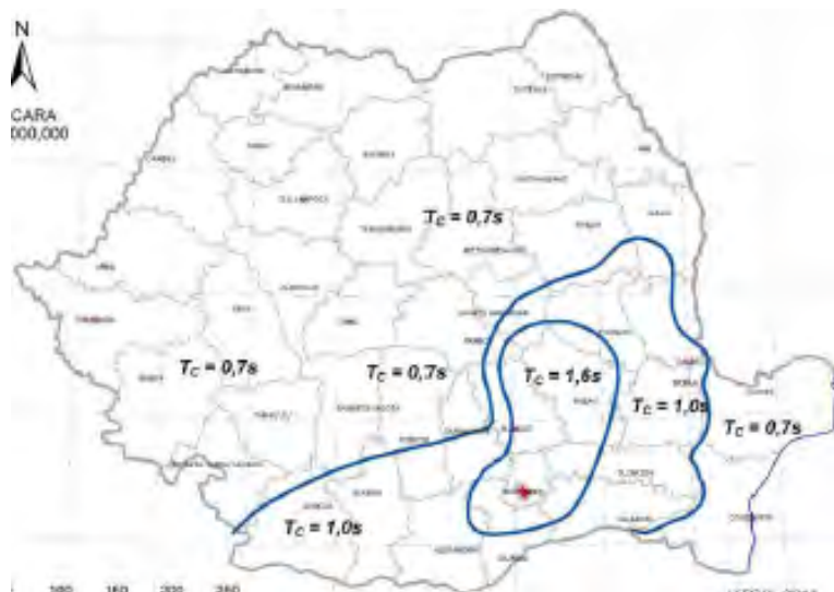
Figura 33 – Zonarea teritoriului în termeni de perioada de control (colt), TC, a spectrului de raspuns
