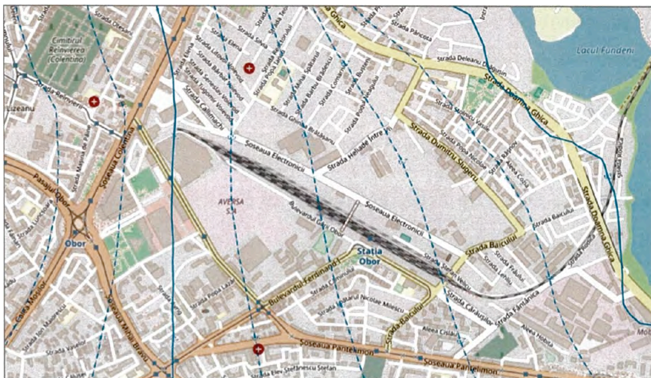
Figura 36 – Harta cu hidroizohipse ale orizontului acvifer de mica adâncime pe sectorul Soseaua Mihai Bravu - râul Colentina (după harta hidrogeologică a orașului București întocmită de UTCB-CCIAS pe baza măsurătorilor piezometrice din decembrie 2014)
