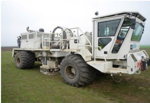
Fig. 11: Vehicul tip Vibroseis echipat cu presa centrală
