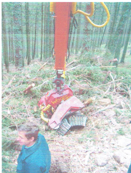
Fig. 5. Combină de fasonare a materialului lemnos recoltat
