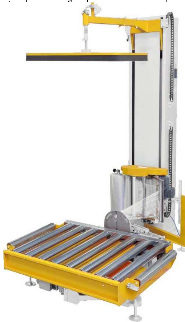
Figură 18: instalație de înfoliere
