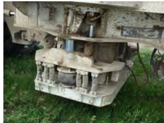
Fig. 11: Vehicul tip Vibroseis echipat cu presa centrală Fig. 12: Presa vehiculului Vibroseis
