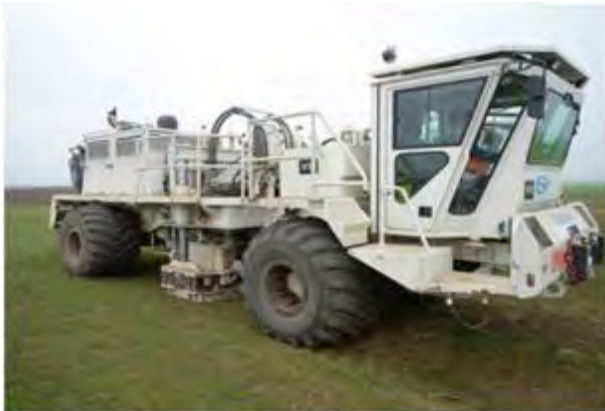
Fig. 11: Vehicul tip Vibroseis echipat cu presa centrală Fig. 12: Presa vehiculului Vibroseis
