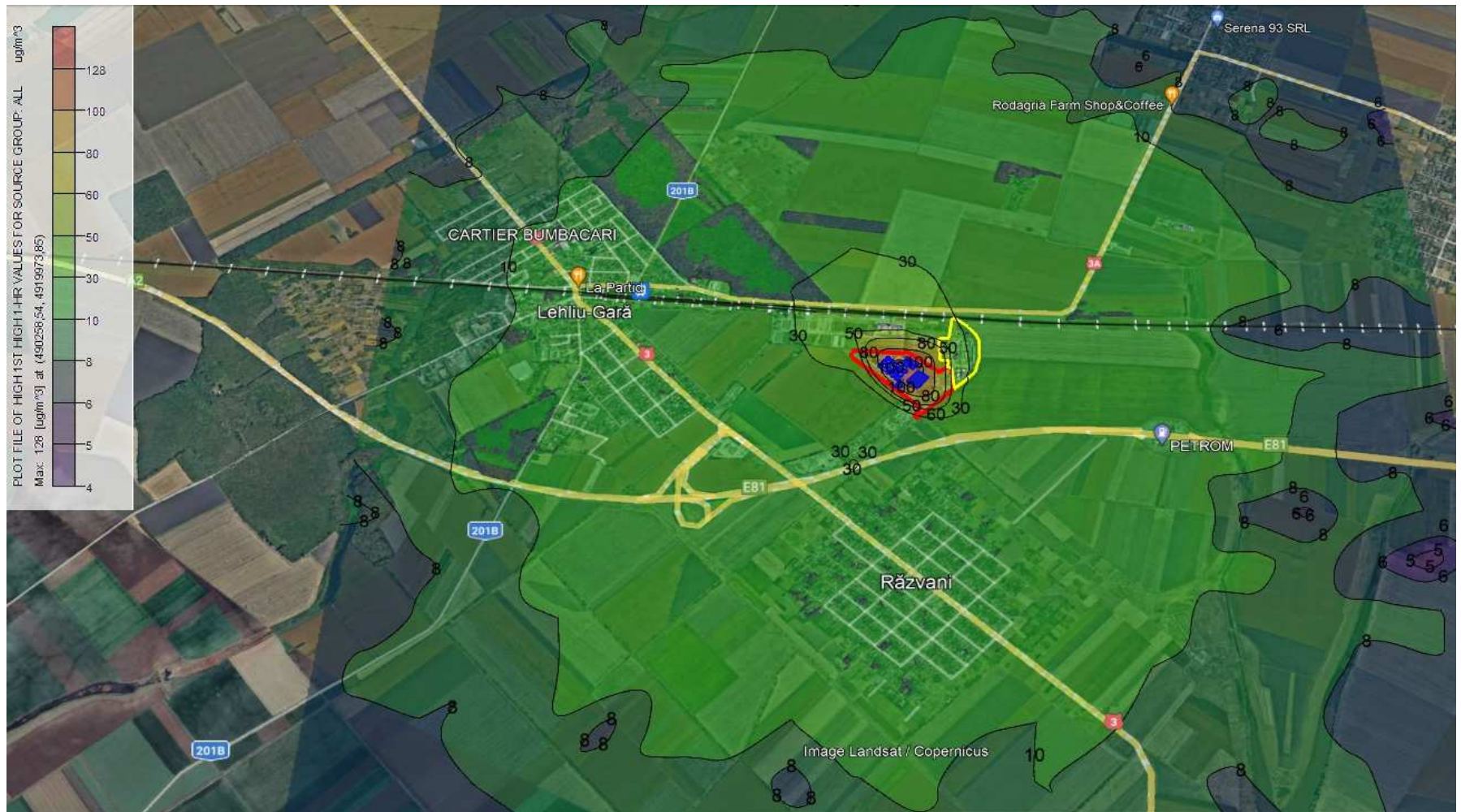
diagramă 20: modelarea variației concentrației de pulberi în imisie înainte de modernizare – perioadă de mediere 1 h
