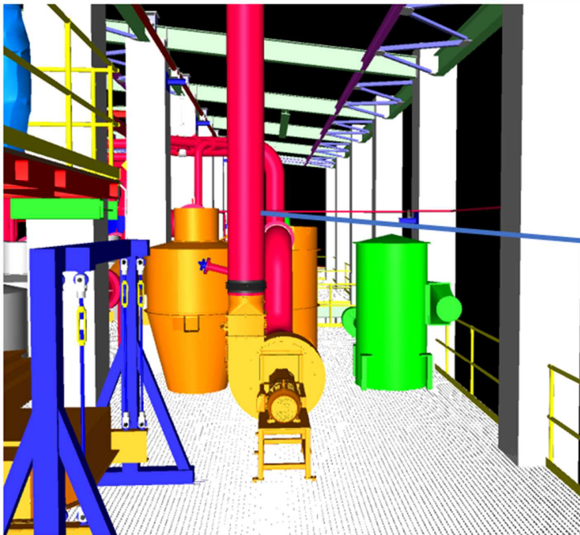
Figură 34: exemplu amplasare ștuț pentru montarea analizorului de gaze în coșul de evacuare a aerului de la exhaustare filtru cu saci 2D903.3
