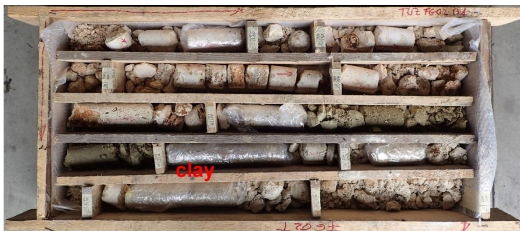
Figura 20. Folie de plastic înfășurată pe intercalațiile de argilă – TUZ_FG02 cutia nr. 1
