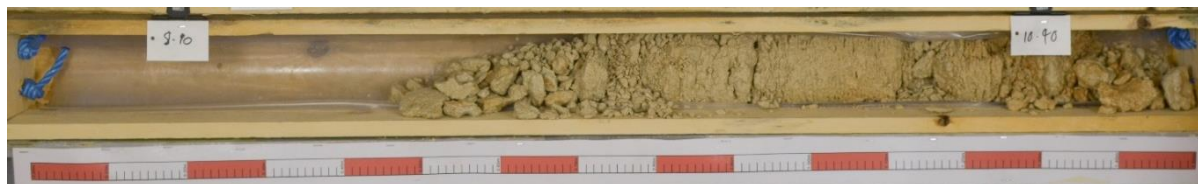
Figura 44. Pământ fărâmițat care tinde spre Pământul Rezidual din Calcarul Sarmațian Mijlociu (Carstic) identificat în Forajul R09-03, 8,90 mbsl - 10,40 mbsl
