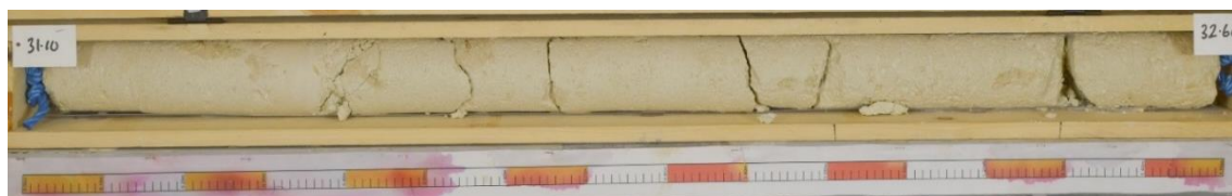
Figura 48. Calcar Sarmațian Mijlociu (Carstic) parțial alterat cu geode umplute sub orizontul principal alterat identificat în Forajul R09-2, 31,10 mbsl – 32,60 mbsl
