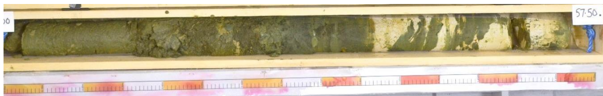
Figura 52. Nisip Verde Sarmațian care tranzitează spre Calcar Lutețian la partea inferioară identificat în Forajul R09-4, 56,00 mbsl – 57,50 mbsl
