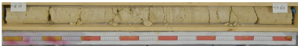
Figura 46. Calcar Sarmațian Mijlociu (Carstic) local alterat cu geode și alte goluri identificat în Forajul R09-1, 16,10 mbsl – 17,60 mbsl
