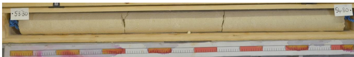
Figura 49. Calcar Sarmațian Mijlociu (Intact) nealterat spre parțial alterat local, fără caracteristici de dizolvare, identificat în Forajul R09-1, 53,30 mbsl – 54,80 mbsl
