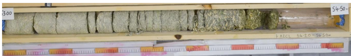
Figura 51. Tranziția de la Calcar Sarmațian Mijlociu (Intact) la Nisip Verde Sarmațian identificat în Forajul R09-4, 53,00 mbsl – 54,50 mbsl
