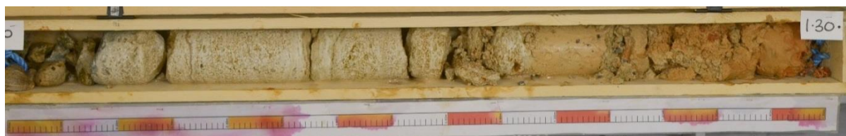
Figura 45. Calcar Sarmațian Mijlociu (Carstic) local fărâmițat cu caracteristici extinse de dizolvare, local tinzând spre Pământul Rezidual (argilă portocalie) identificat în Forajul R09-04, 0,00 mbsl – 1,30m mbsl
