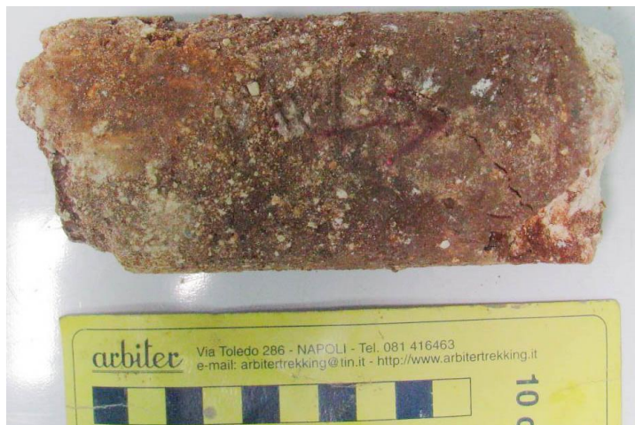
Figura 18. Argilă reziduală – TUZ_FG01 17,46 m
