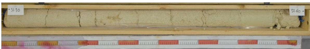
Figura 47. Calcar Sarmațian Mijlociu (Carstic) parțial alterat cu geode umplute sub orizontul principal alterat identificat în Forajul R09-1, 31,10 mbsl – 32,60 mbsl
