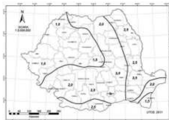
Zonarea valorilor caracteristice ale încărcării din zăpadă pe sol S_k, \text{ kN/m}^2 (CR 1-1-3/2012)
