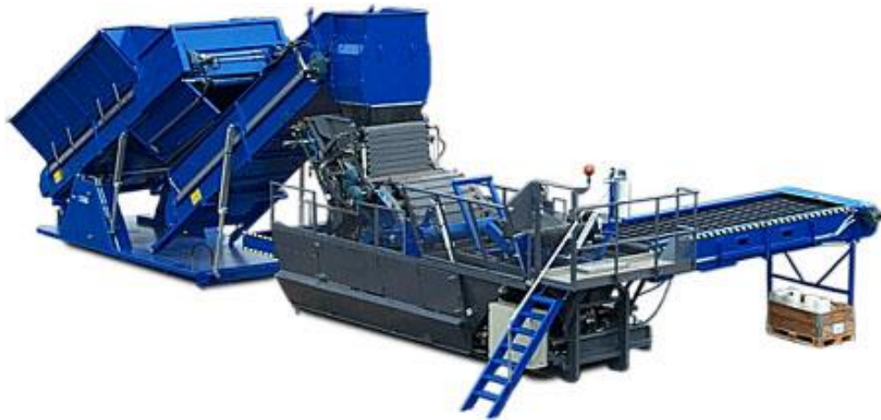
Figura 2-15: Exemplu instalație balotat cu bile rotunde
