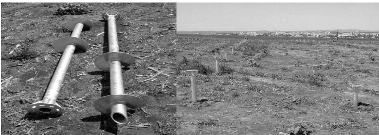
Fig. 55. Modul de fixare al ancorelor în pământ
