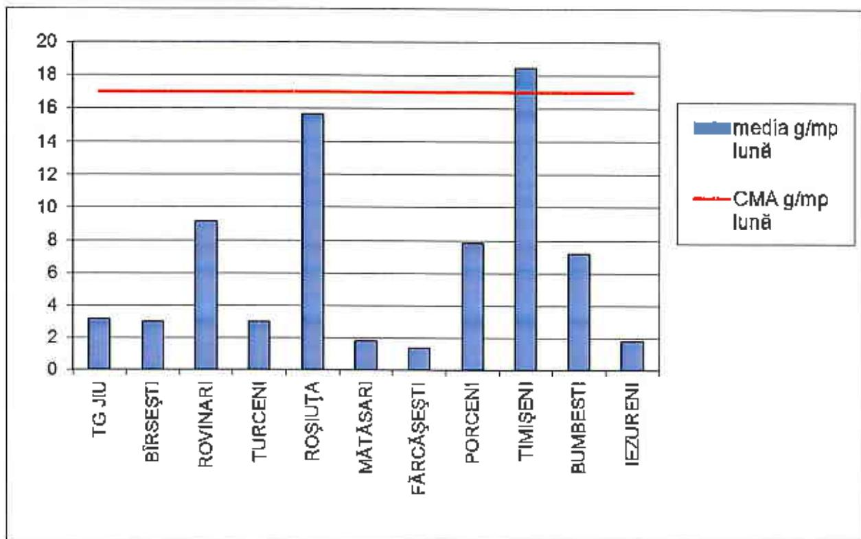
În luna martie, la indicatorul pulberi sedimentabile au fost prelevate probe din mai multe zone ale județului (activități de exploatare a lignitului în cariere, instalații mari de ardere, cariere de extracție minerale, etc) înregistrându-se 6 depășiri a CMA la un total de 52 determinări.
