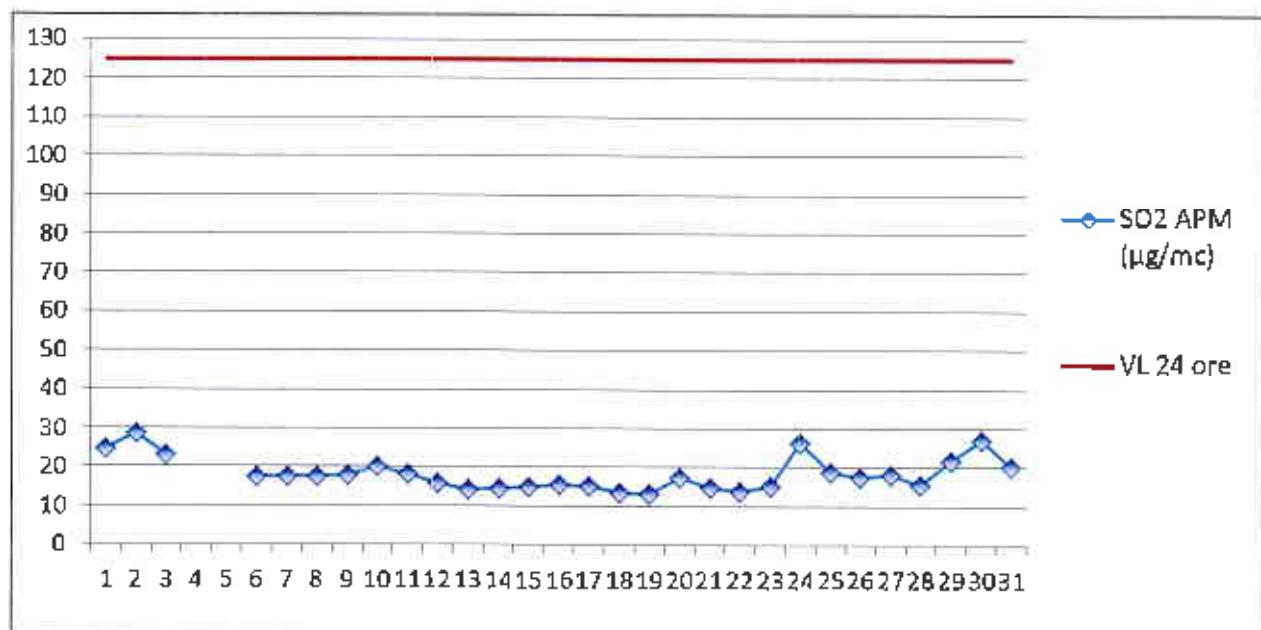
În luna martie, la indicatorul SO<sub>2</sub>, în punctul de monitorizare APM Gorj, au fost efectuate un numar de 695 determinări medii orare respectiv 29 valori medii pe 24 ore. Nu au fost înregistrate depășiri ale VL oră respectiv VL 24 ore.
