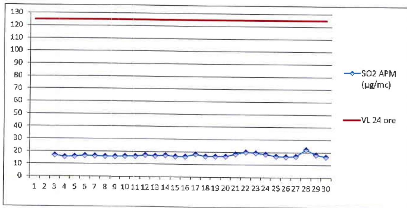
În luna septembrie, la indicatorul SO<sub>2</sub>, în punctul de monitorizare APM Gorj, au fost efectuate un număr de 663 determinări medii orare respectiv 28 valori medii pe 24 ore. Nu au fost înregistrate depasiri ale VL oră respectiv VL 24 ore.
