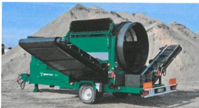
Figura 2.18. Sita cu tambur rotativ pentru cernere compost –tip Komptech Joker
