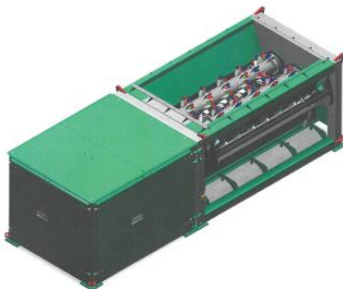
Figura 2.10. Utilaj de mărunțire staționar cu două valțuri CRAMBO 3400 E
