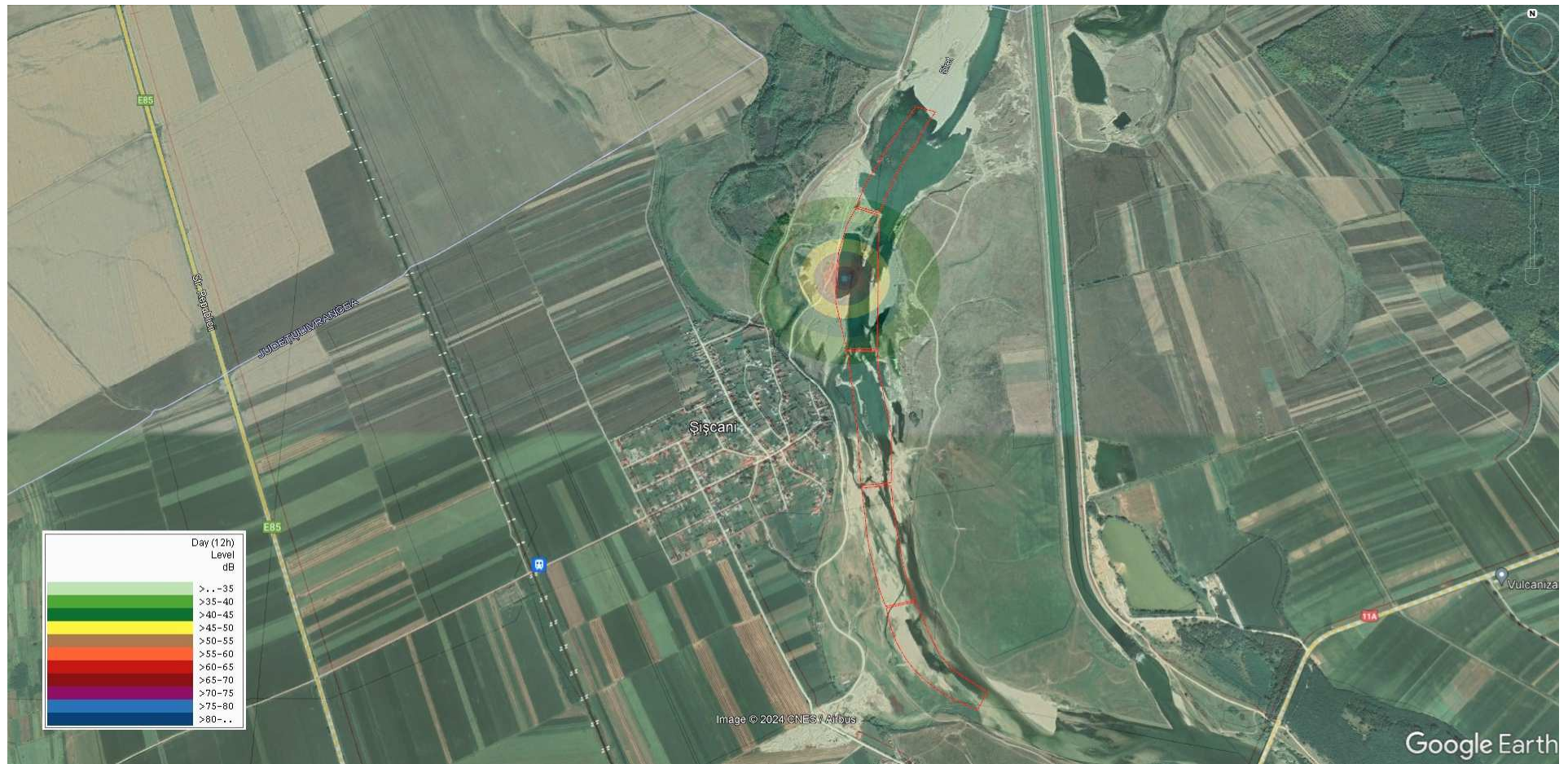
Figura nr. 18 - Hartă propagare zgomot de la perimetrul de exploatare
