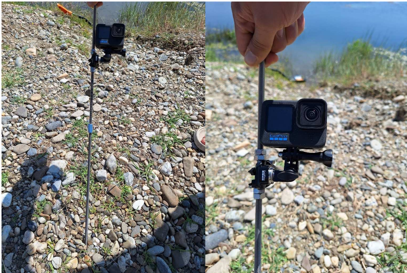
Figură 19 Fixarea camerei de acțiune pe suportul metalic
