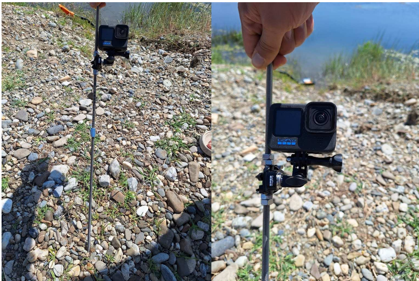
Figură 23 Fixarea camerei de acțiune pe suportul metalic
