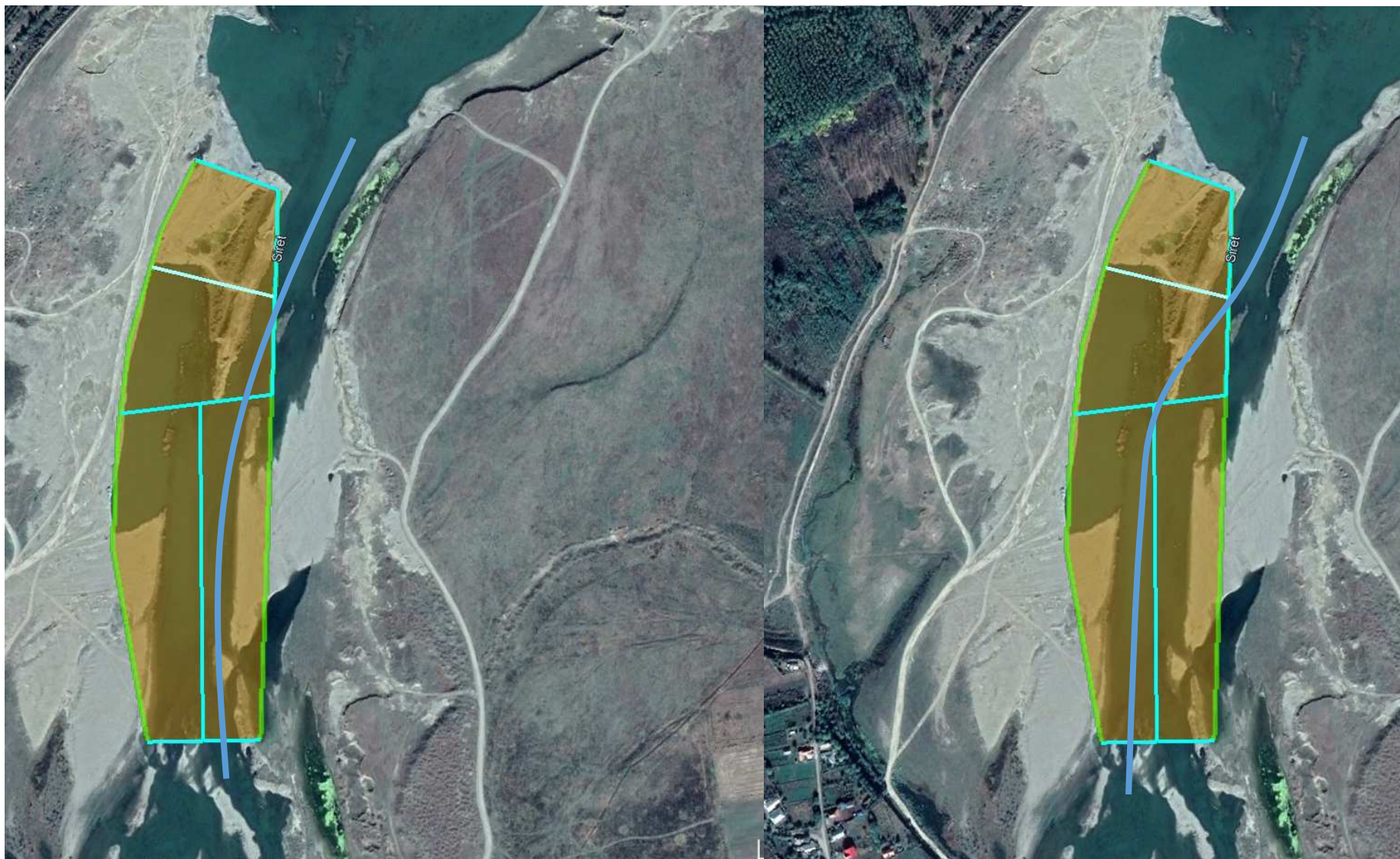
Figură 2 Asigurarea continuității cursului de apă Siret prin executarea primelor 2 bazine închise
