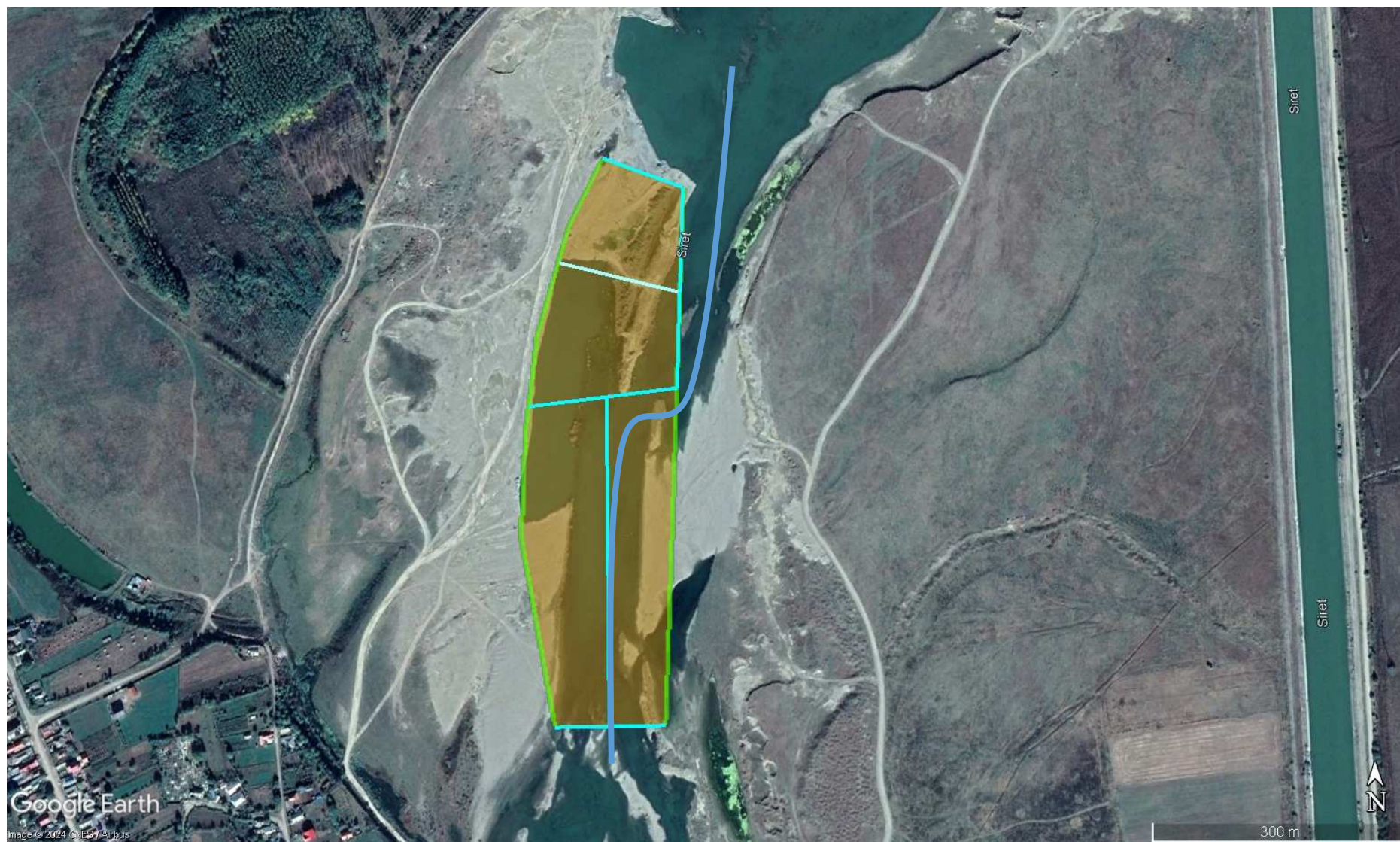
Figură 3 Asigurarea continuității cursului de apă Siret după finalizarea exploatării în bazinele 1 și 2 și începerea decolmatării în bazinele 3 și 4
