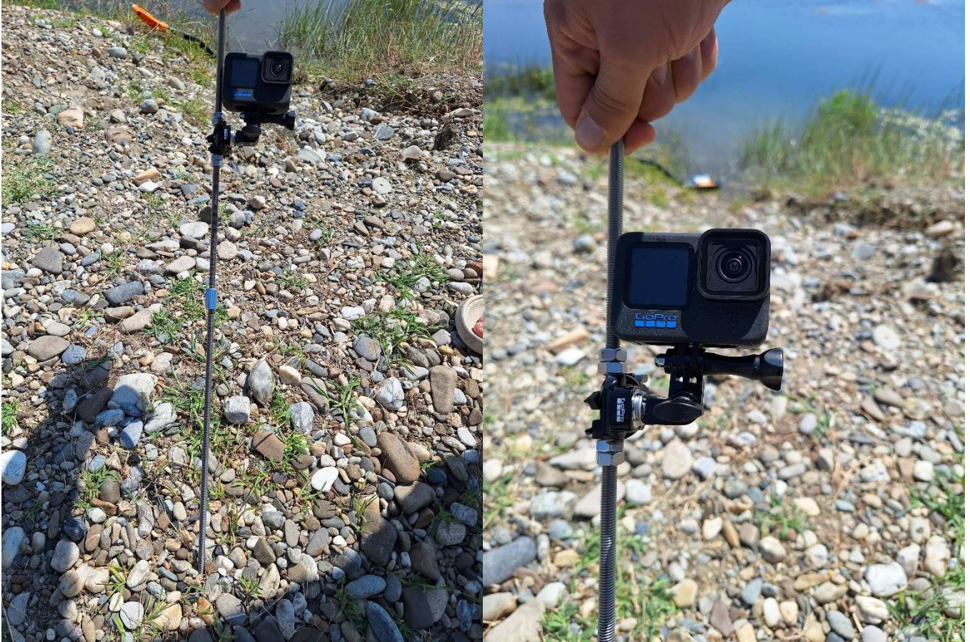
Figură 25 Fixarea camerei de acțiune pe suportul metalic
