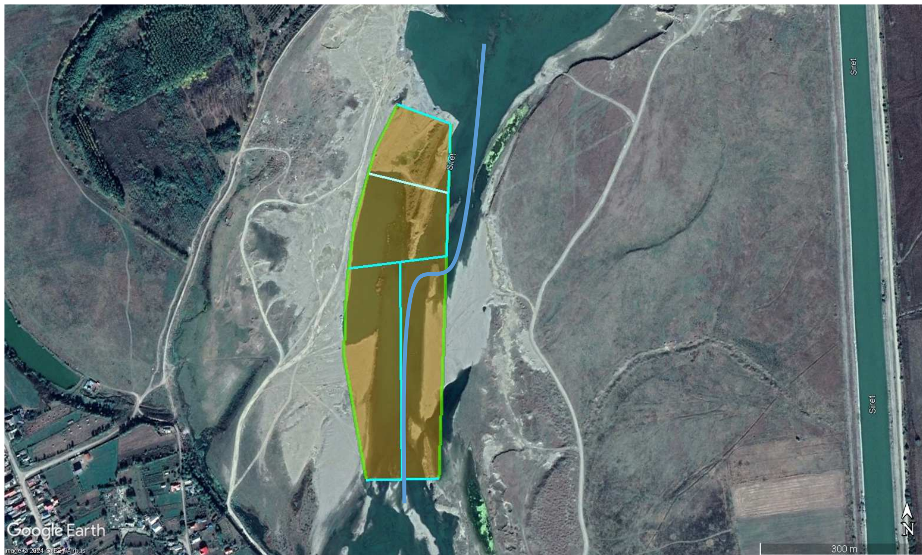
Figura nr. 7 - Asigurarea continuității cursului de apă Siret după finalizarea exploatării în bazinele 1 și 2 și începerea decolmatării în bazinele 3 și 4
