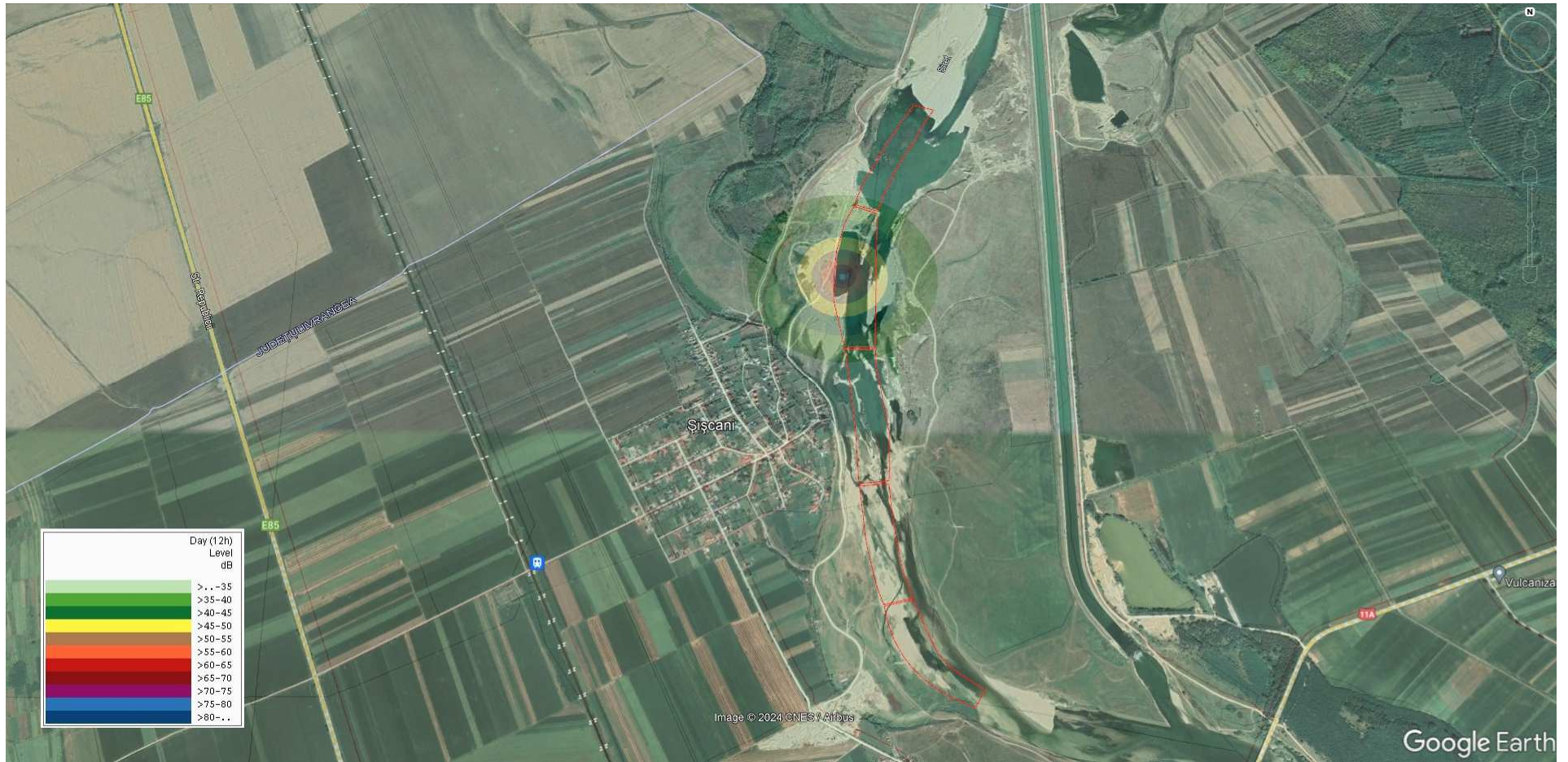
Figura nr. 22 - Hartă propagare zgomot de la perimetrul de exploatare
