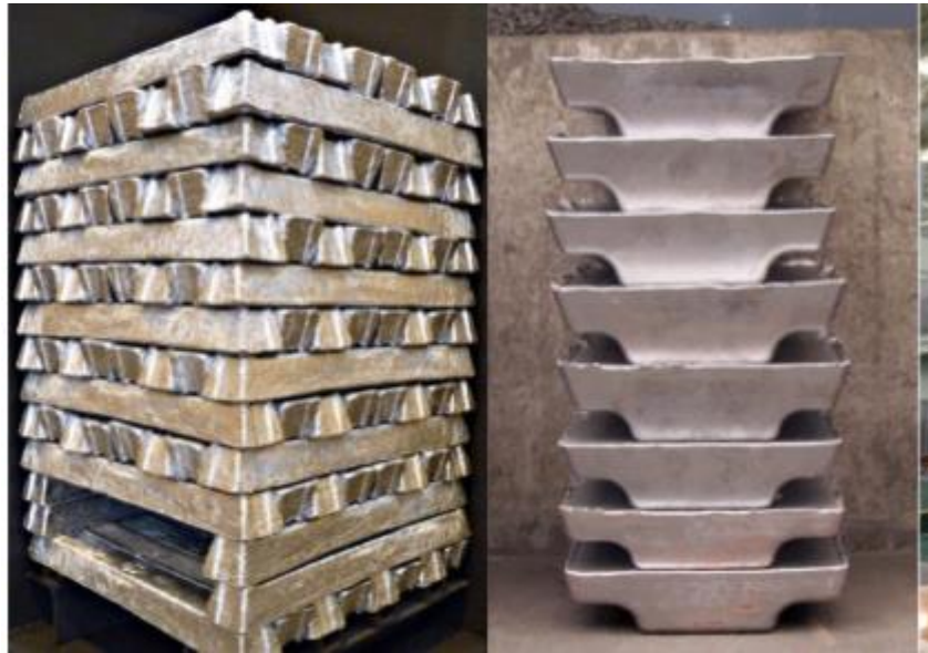
Figura 7. Lingouri de aluminiu rezultate în urma procesului de reciclare
