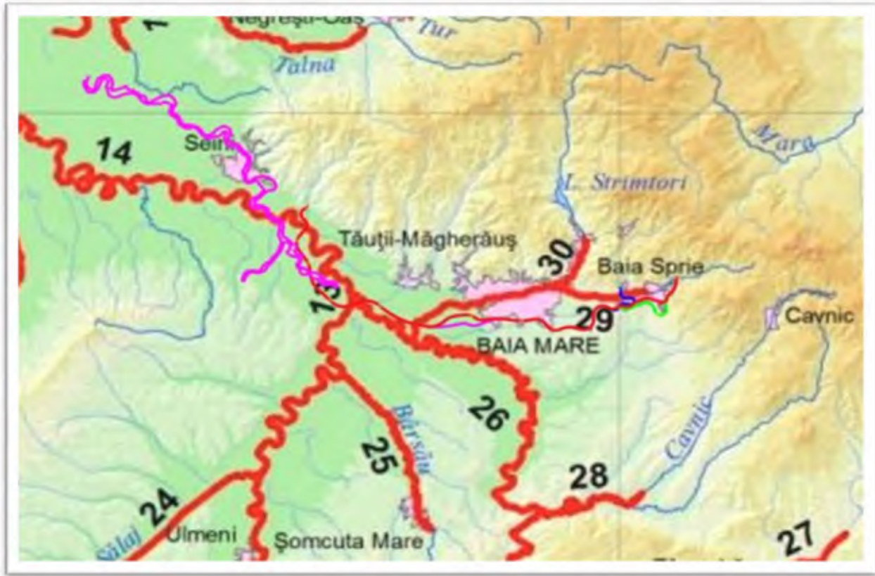
Fig. 43 Zone cu risc potențial semnificativ de inundații (pentru debite maxime cu probabilitatea de depășire de 1%)
