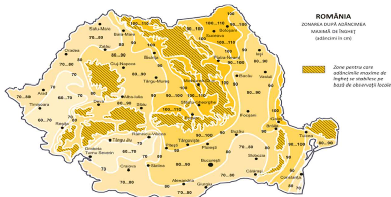
Figura nr. 30: Adâncimea maximă de îngheț în terenul natural, pe teritoriul României
