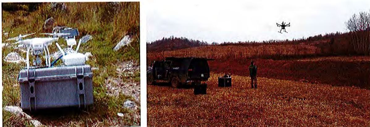
Figura 58. Drona DJI Phantom III-Advanced pregătită de zbor (stânga); Dronă DJI Matrice 600 PRO cu unitate LiDAR
