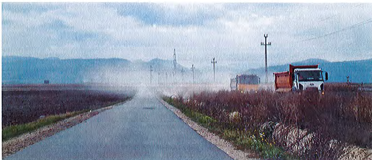
Figura 38. Ilustrarea impactului generat de transport pe un drum nestructurat manifest prin emisia de particule (praf)
