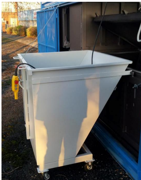
Fig. 3 Detaliu instalație de basculare containere
