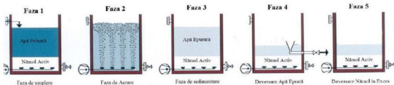
Figura 6. Etapele de operare pentru bazinele cu funcționare secvențială.
