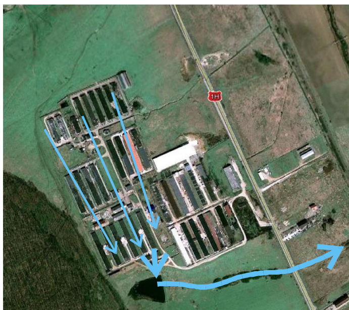
Circuitul apelor pluviale de pe amplasament
