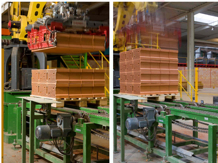
fig. 1: Bratul robotului asezand caramizile fasonate pentru procesul de uscare
