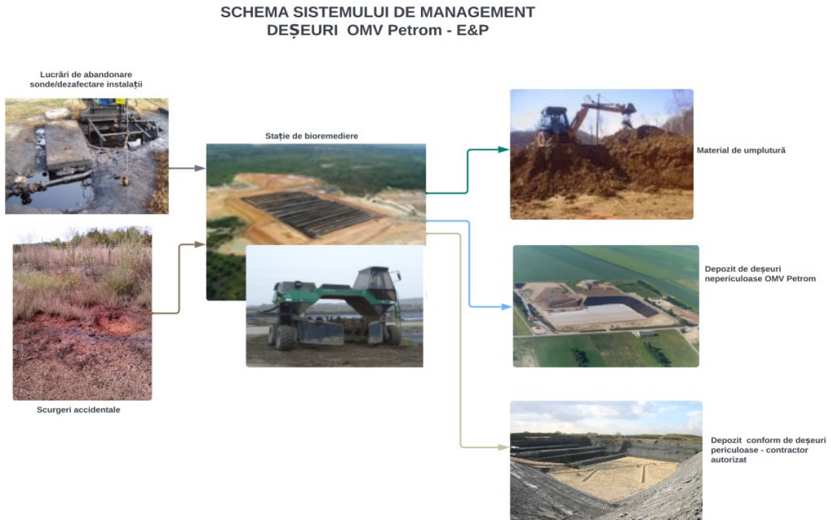
Figura 1: Schema sistemului de management deșeuri OMV Petrom – E&P
