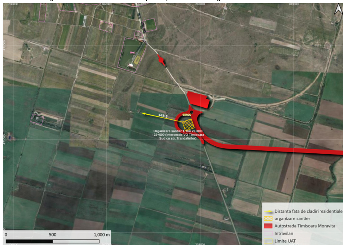
Figura 18 Distanța de la prima cladire pana la amplasamentul organizarii de santier nr 1
