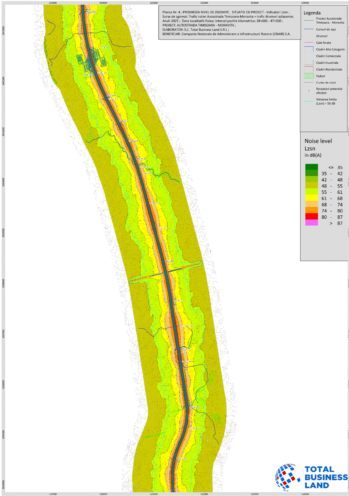
Nivelul de zgomot (Autostrada Timisoara-Moravita; km 47+500 - 56+000) – L ZSN – an 2025 (elementele de detaliu pot fi observate prin cresterea nivelului de zoom a hărților, din ANEXE_HARTI)
