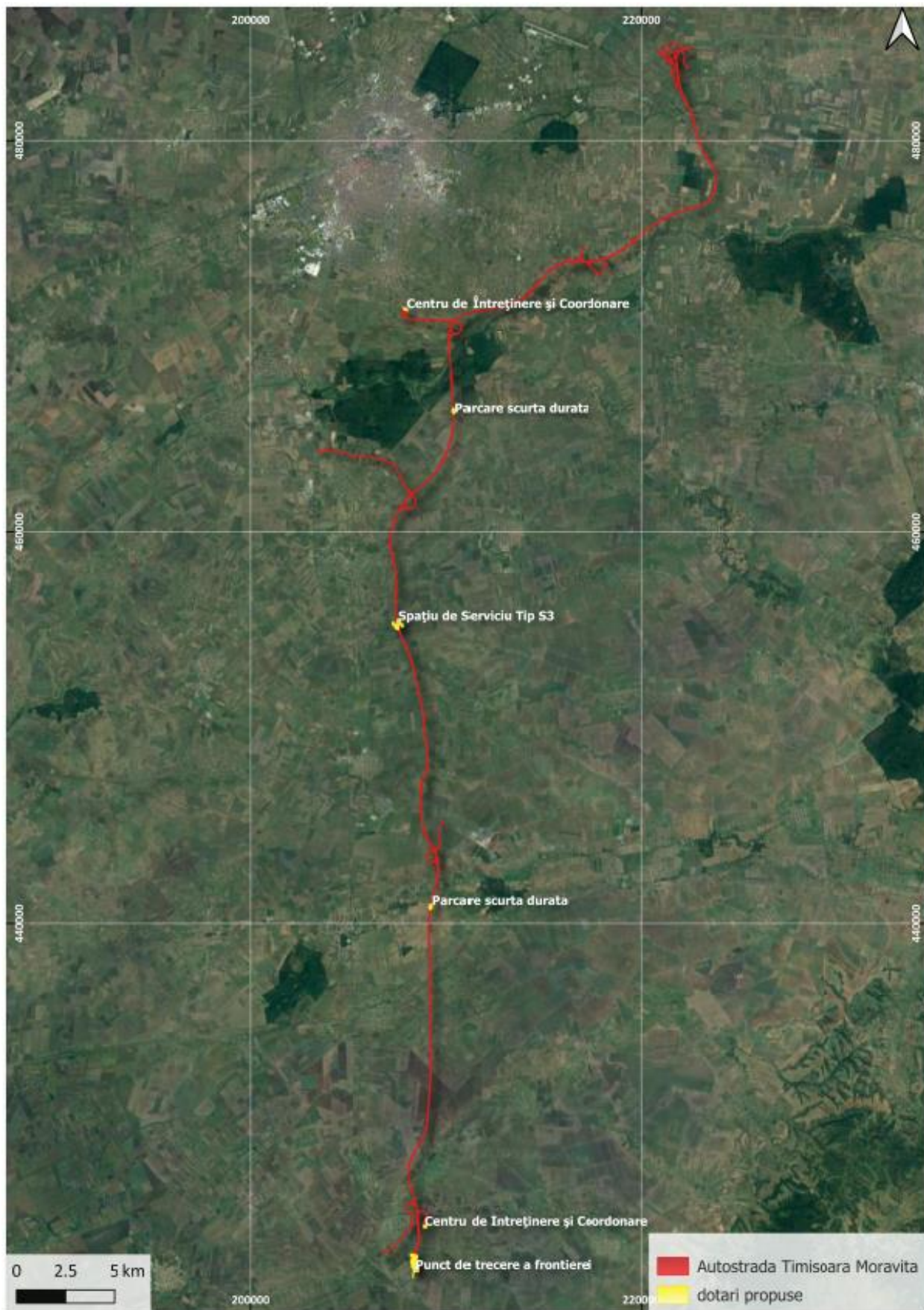
Figura 10 Amplasarea dotărilor propuse - Locații CIC, Spații de serviciu, Parcări de scurtă durată și a Punctului de trecere frontieră de pe autostrada Timișoara – Moravița
