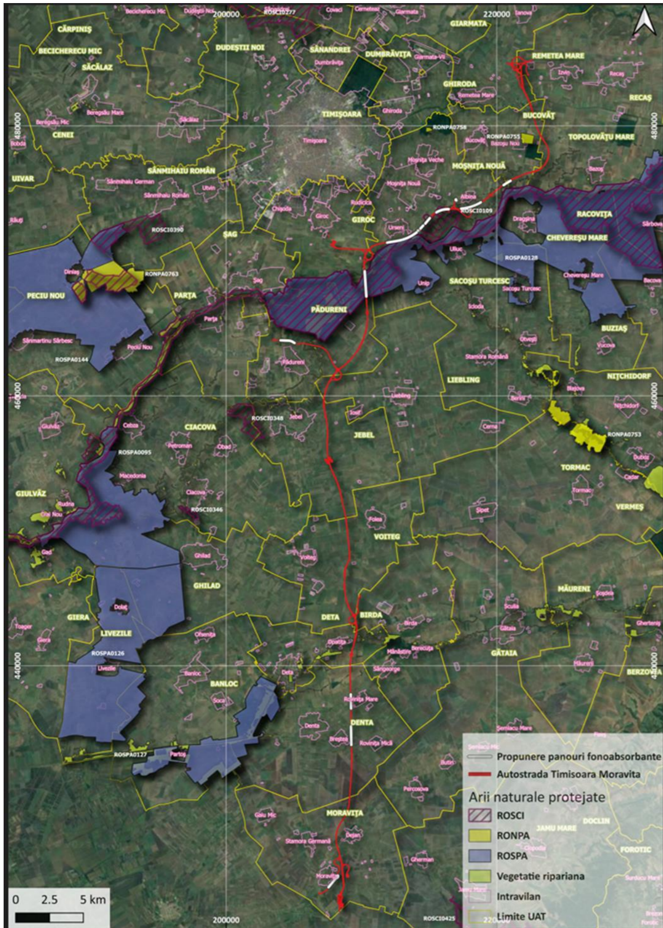
Figura 12 Propunere de amplasare panouri fonoabsorbante si panouri anticoliuziune
