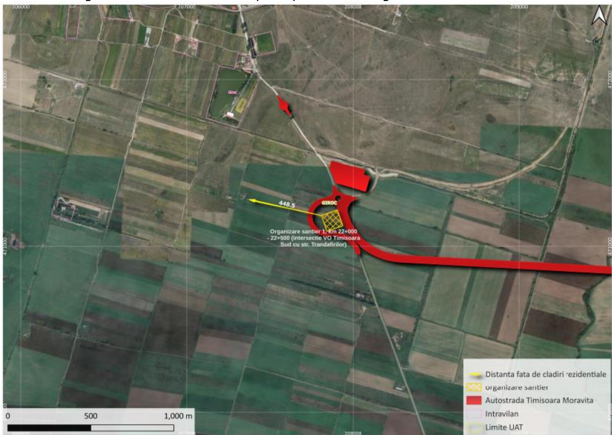
Figura 18 Distanța de la prima clădire până la amplasamentul organizarii de santier nr 1
