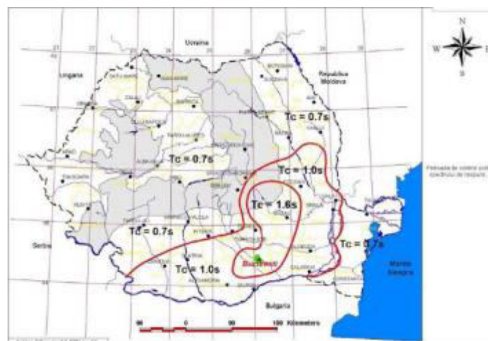
Fig. 16 - Zonarea teritoriului Romaniei în termeni de perioada de control (colt), Tc a spectrului de răspuns. Cod P100-1/2006 ( Elaborator UTCB )
