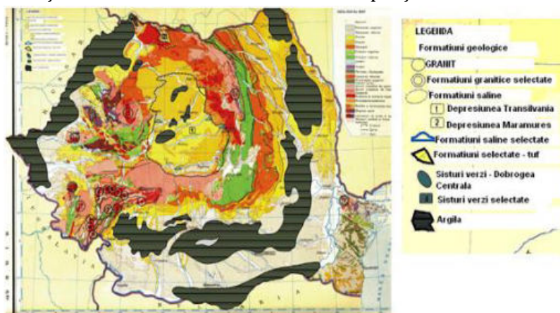
Potențialul formațiuni geologice gazdă pentru depozitul geologic
