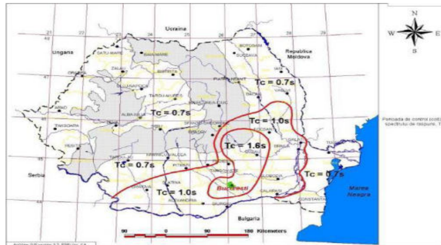
Fig.16 - Zonarea teritoriului Romaniei în termeni de perioada de control (colt), T_c a spectrului de răspuns. Cod P100-1/2006 ( Elaborator UTCB )
