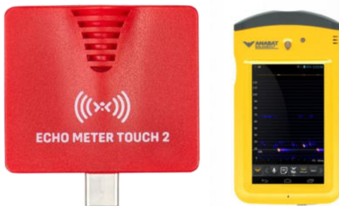
Figura nr 25 – Exemplu echipament monitorizare chiroptere
