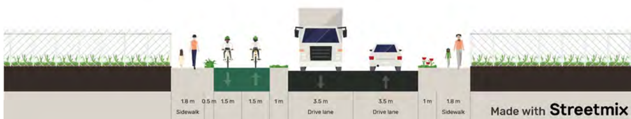
Figura nr. 62 Profil transversal tip 1 - Scenariul Do minimum (pana in 2028) Sector de strada de la Park&Ride Nord pana la I.R.B (sursa streetmix.net)
