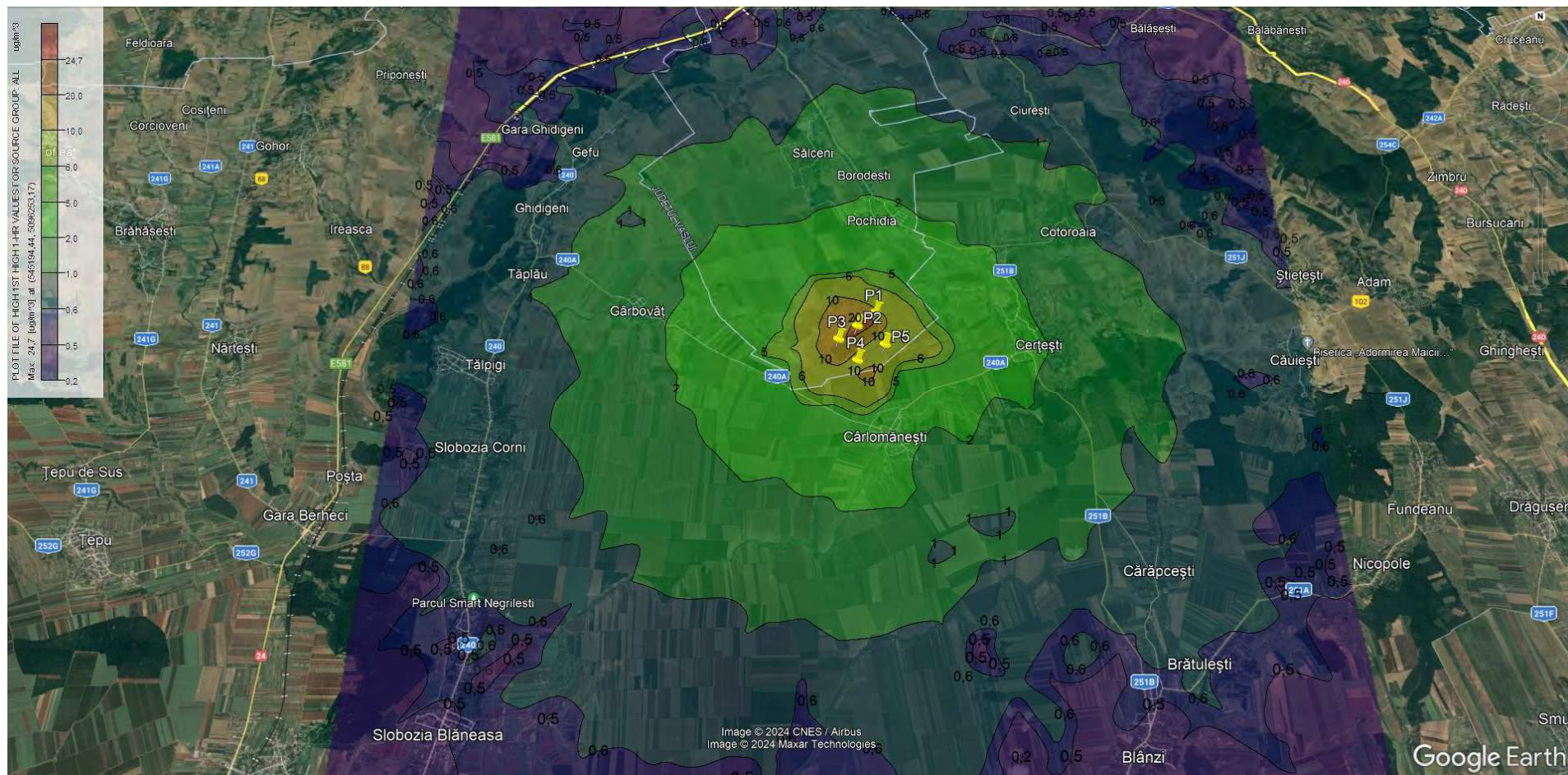
diagramă 43: modelarea variației concentrației în imisie pentru poluantul PM 10 – perioadă de mediere 1 h
