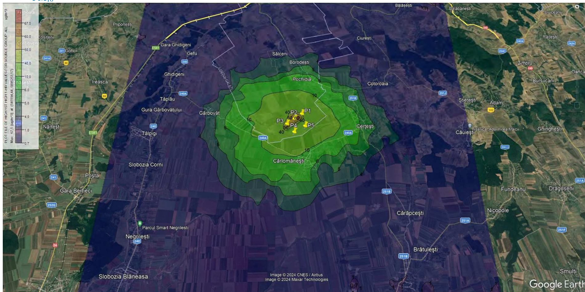
diagramă 7: modelarea variației concentrației în imisie pentru poluantul PM 10 – perioadă de mediere 1 h
