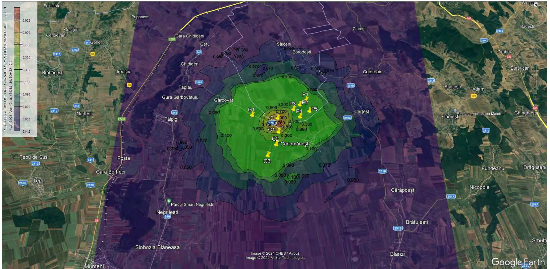
diagramă 97: modelarea variației concentrației în imisie pentru poluantul PM 10 – perioadă de mediere 1 h
