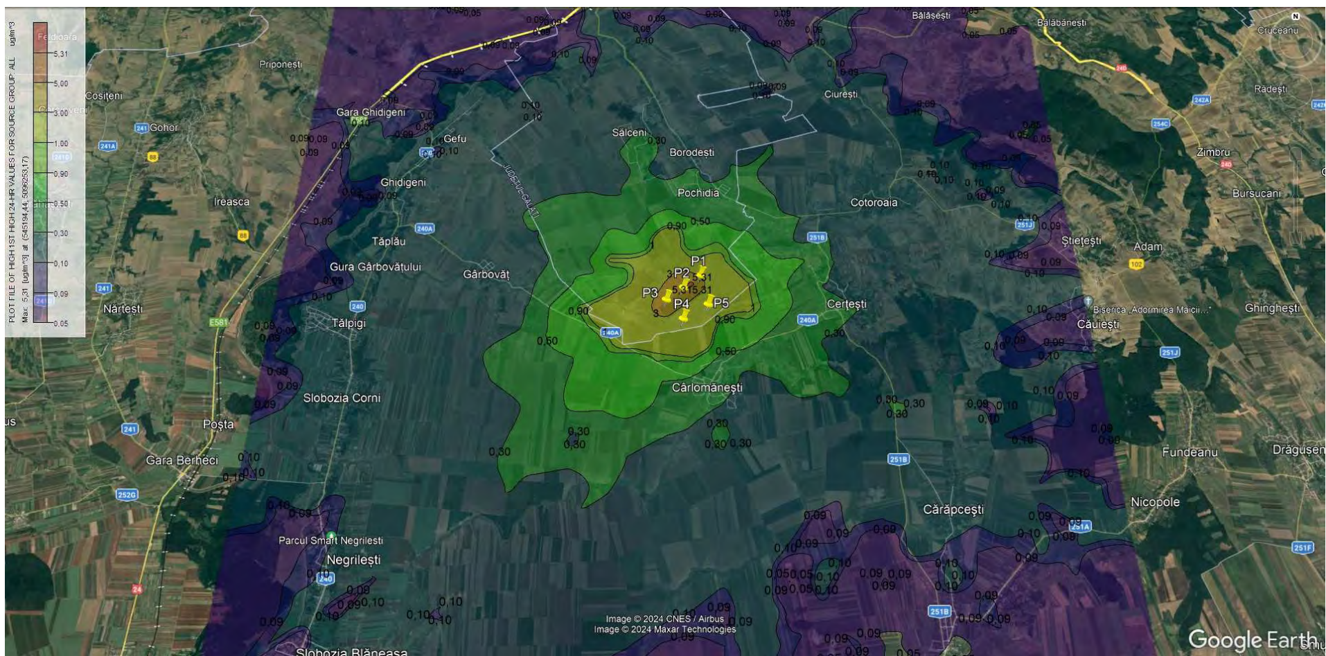
diagramă 8: modelarea variației concentrației în imisie pentru poluantul PM 10 – perioadă de mediere 24 h
