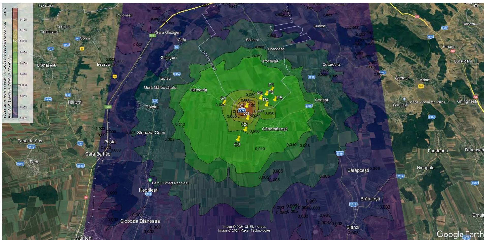
Diagramă 73: modelarea variației concentrației în imisie pentru poluantul PM 2,5 – perioadă de mediere 1 h
