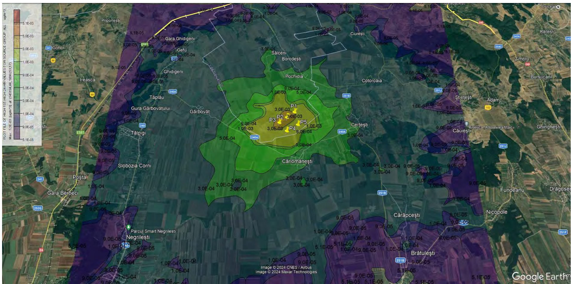
diagramă 38: modelarea variației concentrației în imisie pentru poluantul PM 2.5 – perioadă de mediere 24 h
