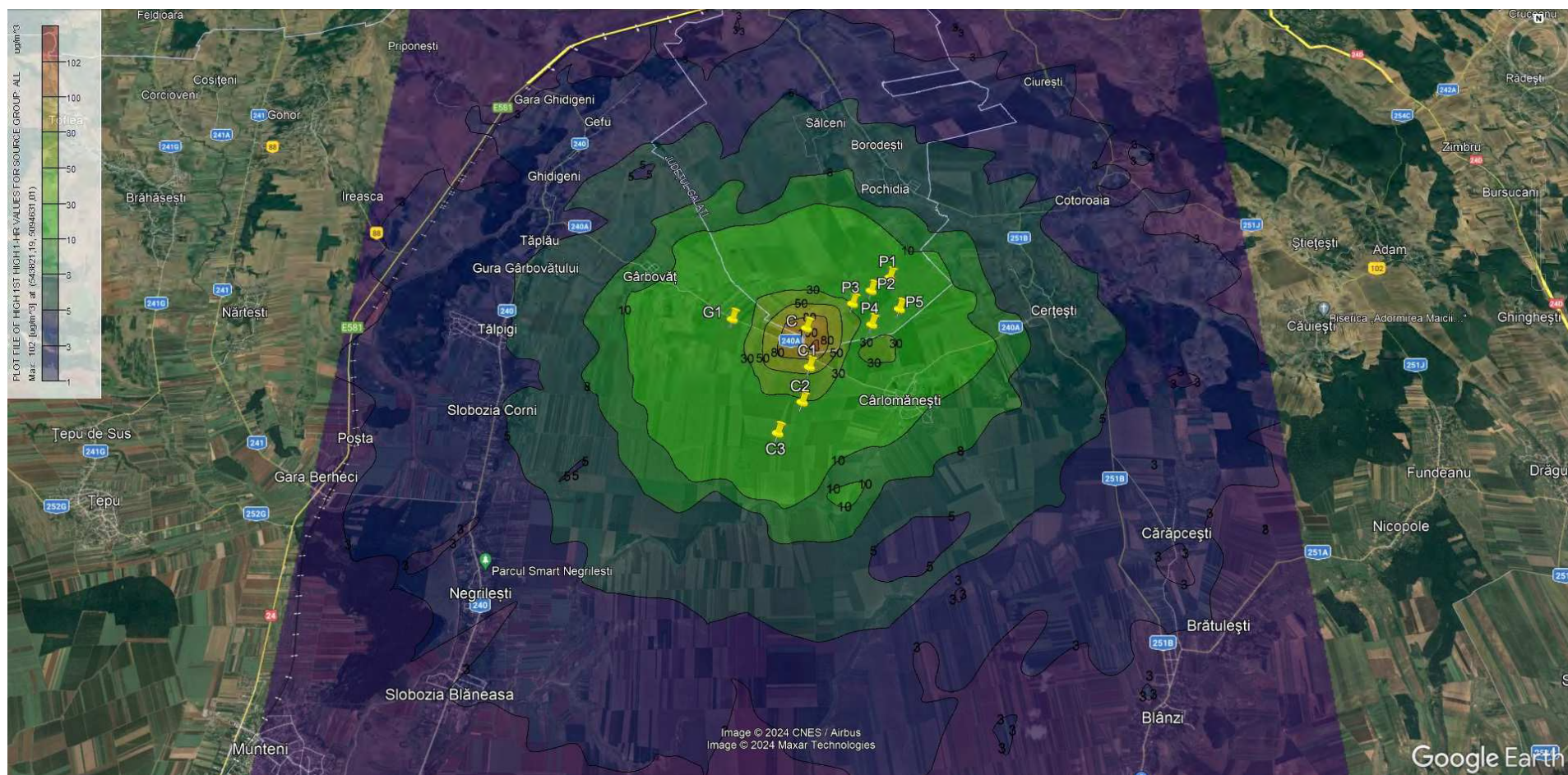
diagramă 61: modelarea variației concentrației în imisie pentru poluantul PM 10 – perioadă de mediere 1 h
