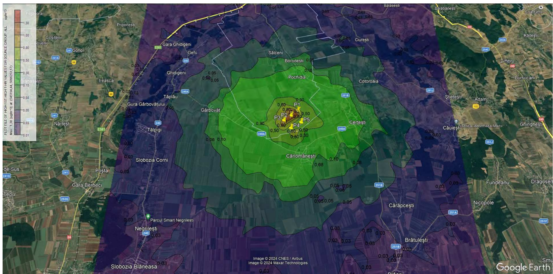
diagramă 16: modelarea variației concentrației în imisie pentru poluantul PM 10 – perioadă de mediere 1 h
