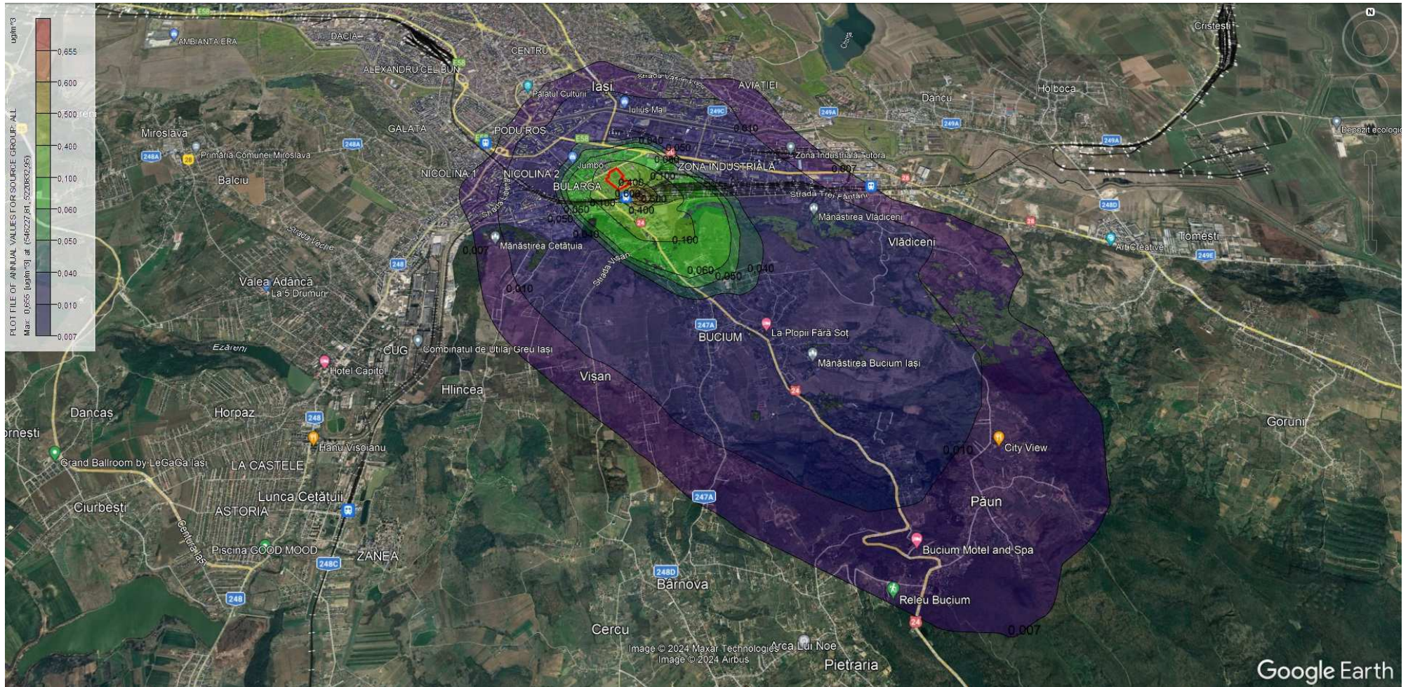
diagramă 21: modelarea dispersiei poluantului SO 2 – perioadă de mediere 24 h
