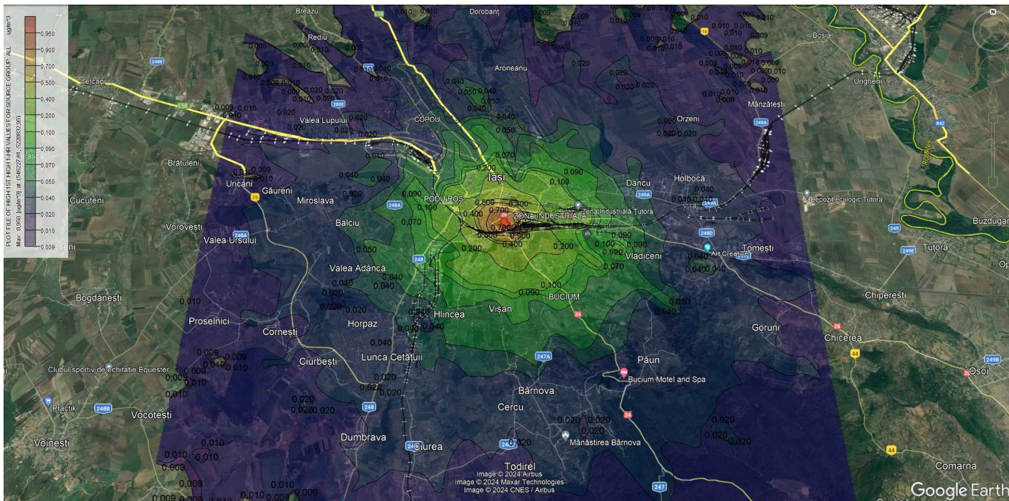
diagramă 18: modelarea dispersiei poluantului NO 2 – perioadă de mediere 1 h
