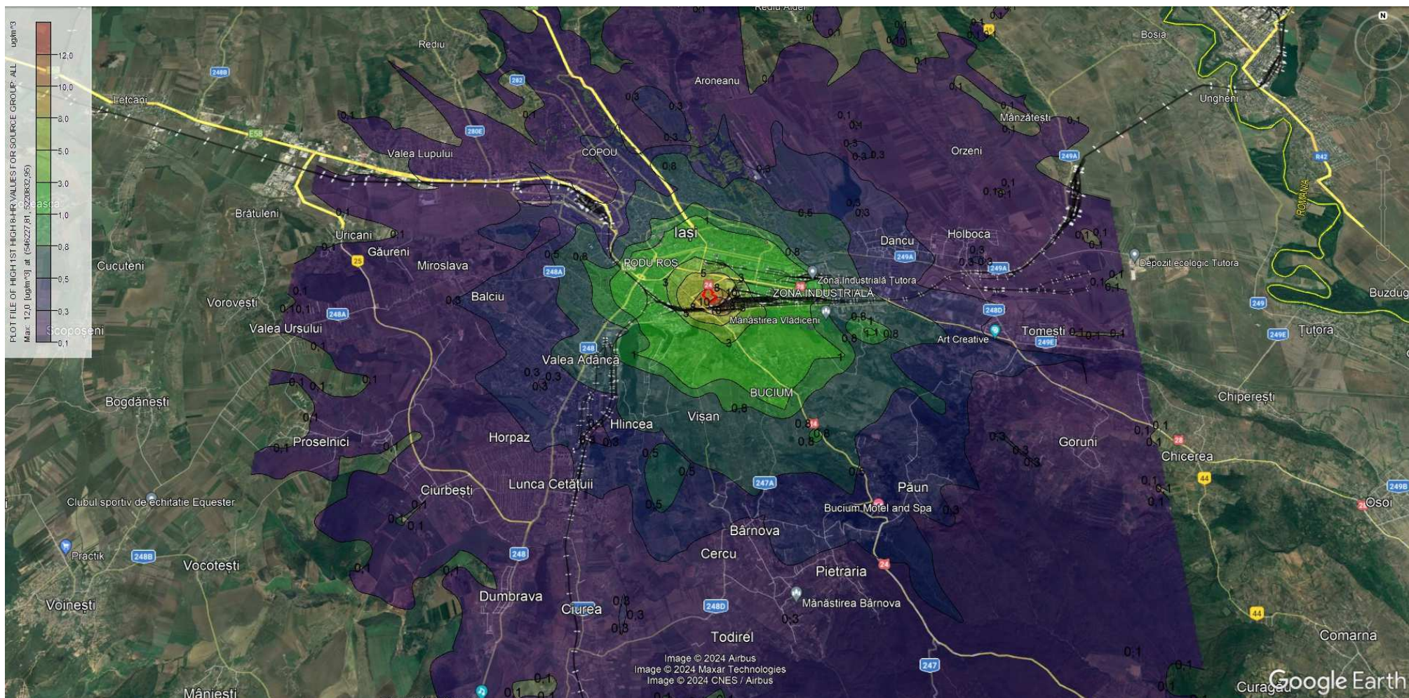
diagramă 6: modelarea dispersiei poluantului PM 10 – perioadă de mediere 8 h
