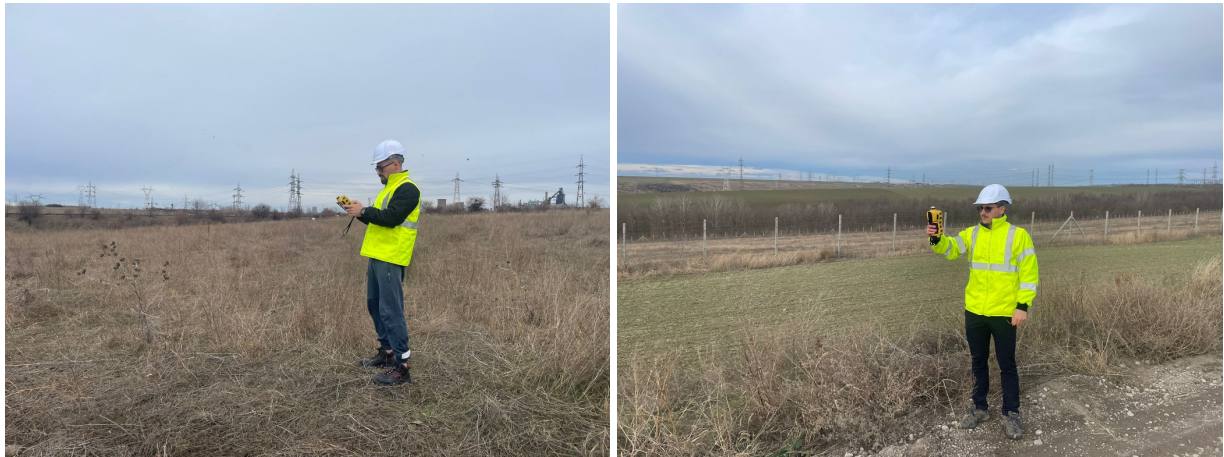
Foto 6.2. Prelevare și măsurare de aer - imisii: SO 2 , NO, NO x și NO 2
