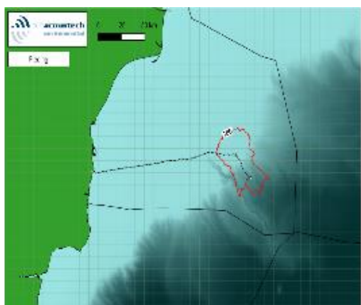
Figura 6.92 Nivel de expunere la zgomot impuls cumulat SELcum pentru pești (Popper et al., 2014) cu ciocanul utilizat la energie maximă pentru instalarea unui singur pilon, izolinia exterioară este limita TTS iar cea interioară \geq 203 dB
