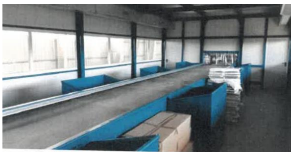
Figura 6 – Banda sortare 1.200 x 18.000 mm
