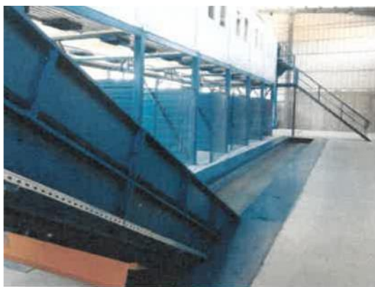
Figura 14 – Banda înclinată cu racleti pentru alimentare presă de balotat
