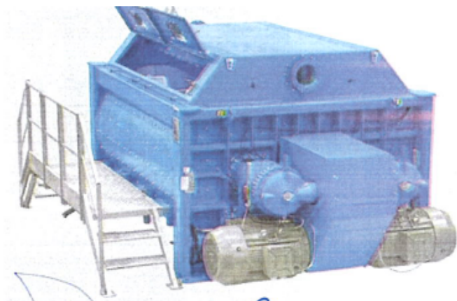
Figura nr. 12 – malaxorul stației de betoane
