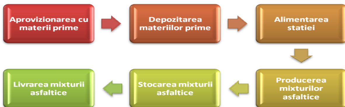
Figura nr. 7 – fluxul tehnologic preparare mixturi asfaltice
