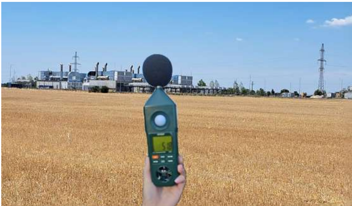
Figura nr. 6-1 Aparatul multiparametru utilizat pentru prelevare date de zgomot in timp real pe amplasamentul VERMONT GREEN ENERGY S.R.L
